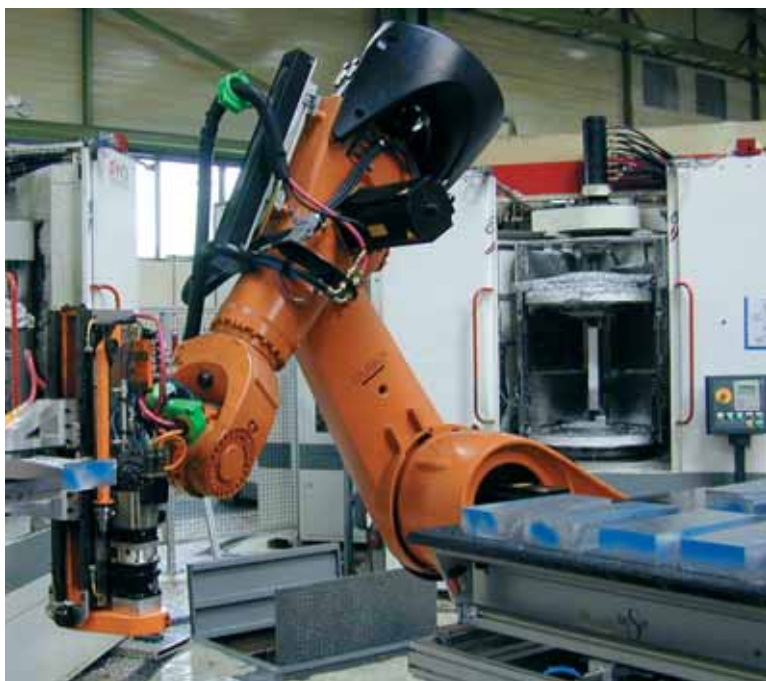
Usinage grande vitesse avec alimentation robotisée.
